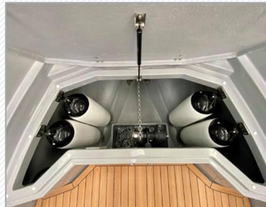
La baille à mouillage est conçue pour intégrer le guindeau électrique avec télécommande, une ancre en acier inox Ultramarine de 12 kg, avec la chaîne, et les cordages et pare-battage.
