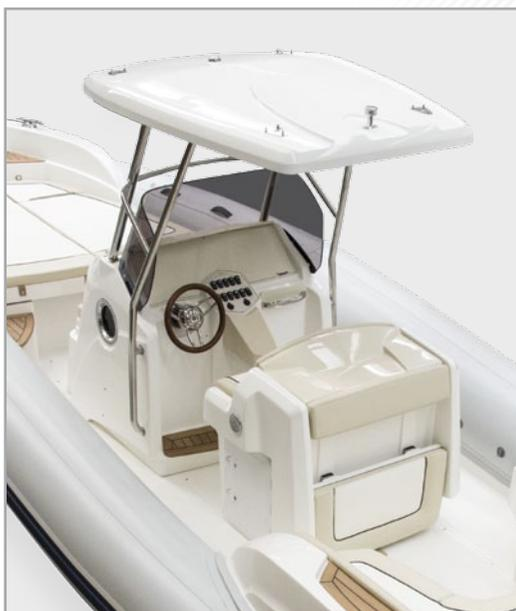
Console équipée de main-courante en acier inox, volant, Système de direction, parebrise anti-reflets, espace pour l'installation des instruments de bord et siège avant pour deux passagers. Hard top inox et fibre (option)
