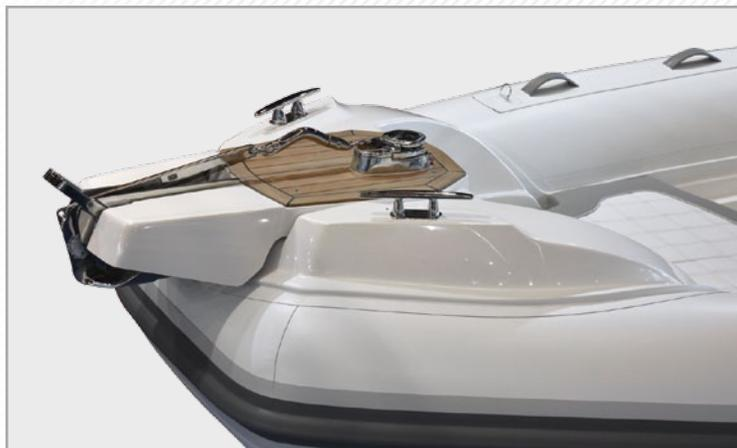
Console équipée de main-courante en acier inox, volant, système de direction, parebrise anti-reflets, espace pour l'installation des instruments de bord et siège avant pour deux passagers
